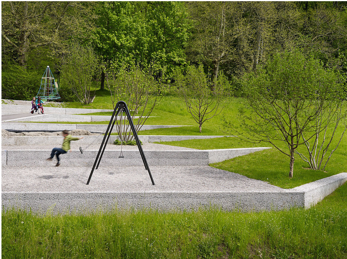
Abbildung: Sitzhohe Böschungsmauern aus Sickerbeton Projekt: Schulanlage Göttibach Thun; extra Landschaftsarchitekten AG, Bern Fotograf: Milo Keller (Bildrechte vorliegend)
