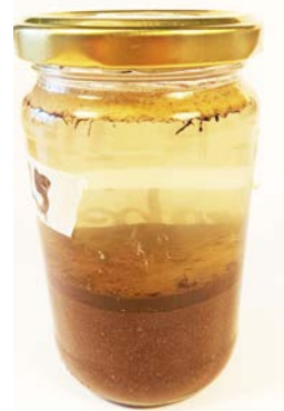
Abb. Bodenschnelltest - Probeentnahme-Standort, 15.11.2024, 13:00 Uhr und Bodenschnelltest – Probeentnahme 24 Std. im Wasser
